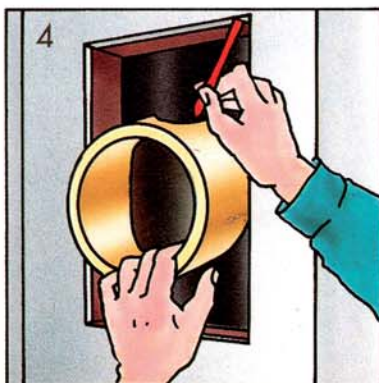
4 Mit dem Sattelstück als Maß an der Dämmung den Ausschnitt anzeichnen.
