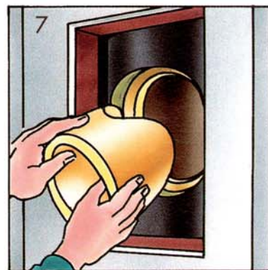
7 Das Sattelstück an dem ausgeschnittenen Rauchrohranschluß anpassen.
