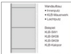
Einschaliges Mauerwerk (monolithisch)
