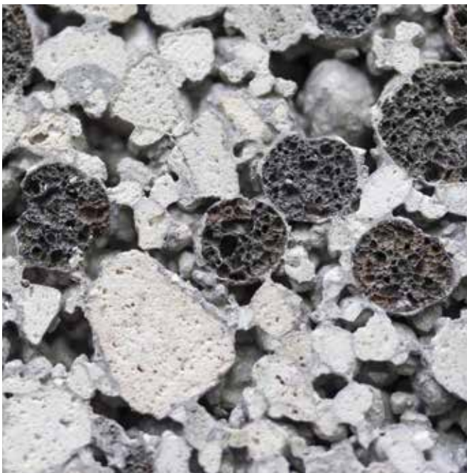
Bild 2.1: Haufwerksporiger Leichtbeton mit porigen Zuschlägen. Foto: Bundesverband Leichtbeton
